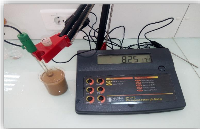
Figure III.1. pH-mètre (HANNA instrument 211).
