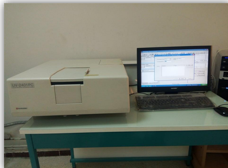
Figure III.4. L'appareil d'UV-Visible (SHIMADZU UV – 2401 PC).
