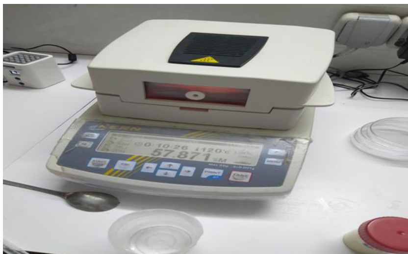
Figure .17: la chambre chaude du dessiccateur.
