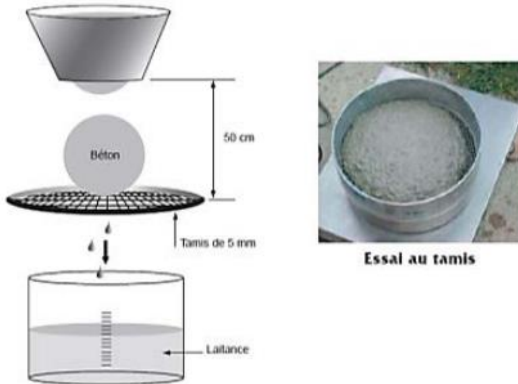
Fig. I.9. Essai de stabilité au tamis.
