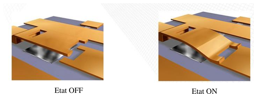
Figure II.1 : Une commutation en utilisant une poutre métallique [23]
