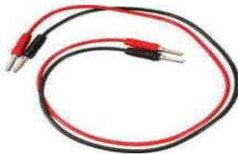
Fig.III.14. Câbles de connexion
