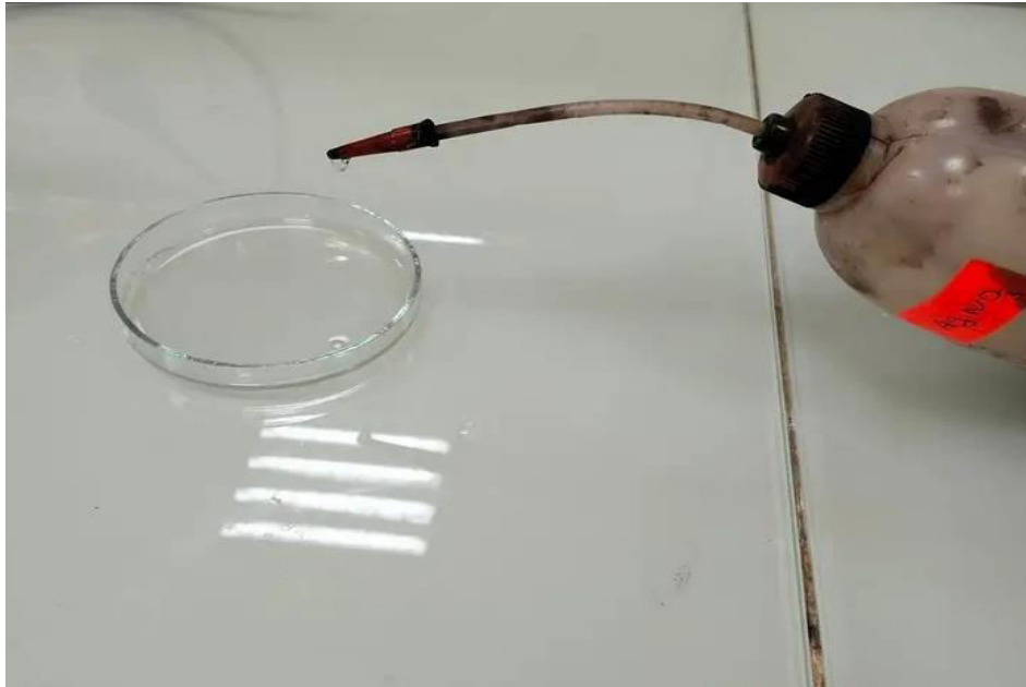
Figure. II.4: La vérification de l'absence du chlore se fait par ajout d'une goutte d' \text{AgNO}_3 à chaque eau de lavage.
