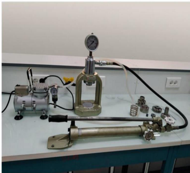
Figure. II.7: Presse pour préparation de pastille KBr.
