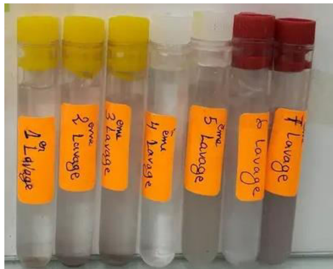
Figure. II.3: Tests de chlore suite à différents lavages.
