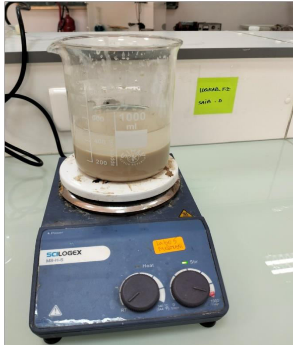
Figure. II.2 : Préparation de la Mte-Na.
