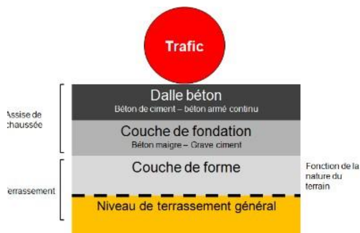
Figure I.15 Structure d'une chaussée semi-rigide.
