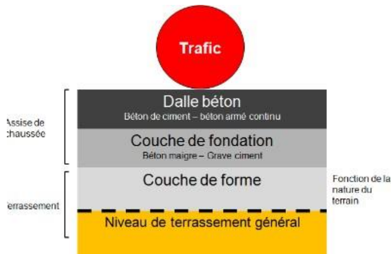
Figure I.18 Chaussée en béton de ciment
