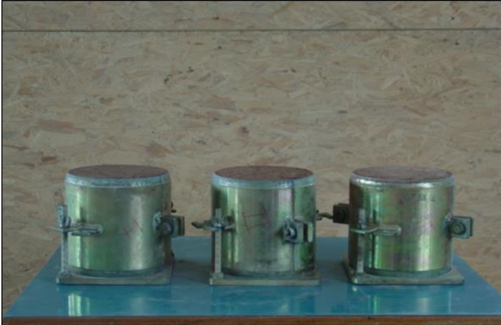
Figure I. 14 : Éprouvettes de BCR préparées selon le procédé Proctor modifié (ZDIRI M 2008).
