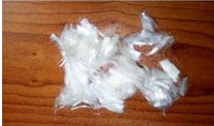
Figure III. 3 : Fibres polypropylènes utilisés pour cette étude.
