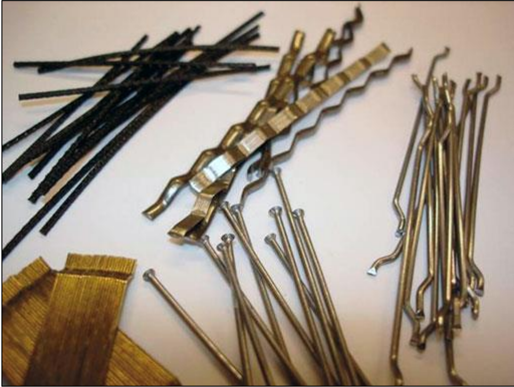
Figure II. 3 : Photos de différentes fibres métalliques pour bétons(CT 2014).
