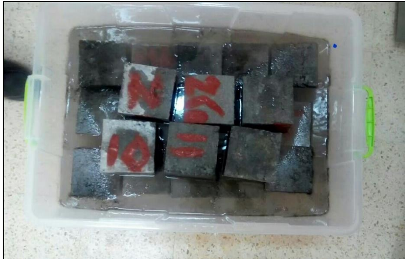
Figure III. 13 : Les échantillons de BCR immergés dans des solutions de H 2 SO 4 (3.5 % et 5 %).
