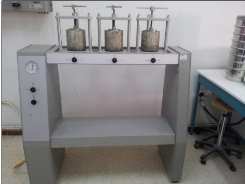
Figure III. 10 : Perméamétrie à l'eau pour béton.
