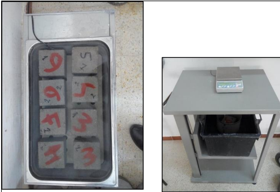
Figure III. 8 : Bain bouillon et pesée hydrostatique pour la porosité accessible à l'eau.
