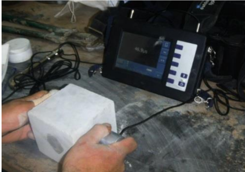
Figure III. 9 : Mesure de la vitesse du son.
