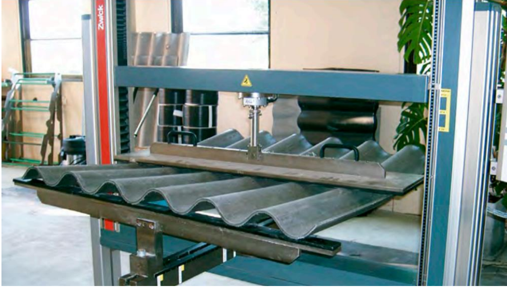
Photo 2.20- Essais de flexion sur des plaques en amiante-ciment.
