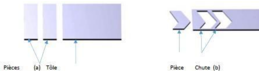
Figure I-1: exemples de découpage, (a) découpe à longueur, (b) découpe de pièces
