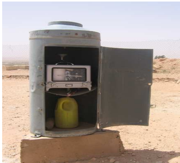
Figure II. 5. Le pluviographe à augets basculeurs
