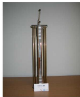
Figure 2.20. Antenne BIE-M coaxiale omnidirectionnelle et ses diagrammes de rayonnement
