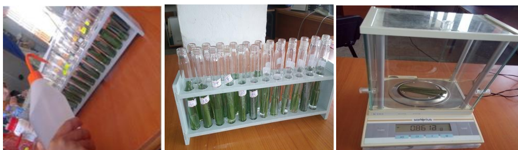
Figure 04 : Images illustrant la mesure de la teneur relative en eau (Photo originale)
