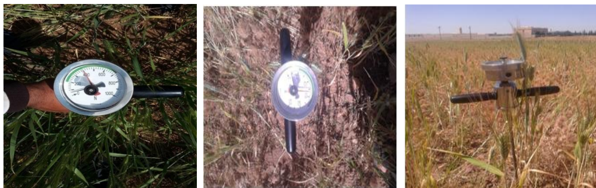
Figure 03: Photo illustrative de la mesure de la résistance à la pénétration par pénétromètre (photo originale).
