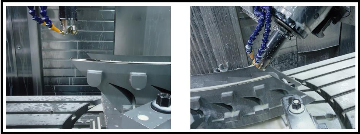
Figure. IV.4. Les Opérations des surfaçages (face 1et 2) par la fraise à copier \Phi 50 .
