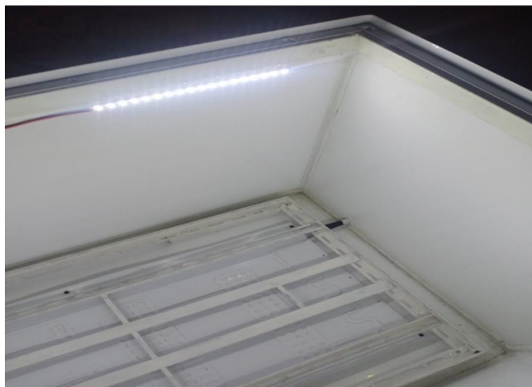
Figure3.14 : L'installation des LED
