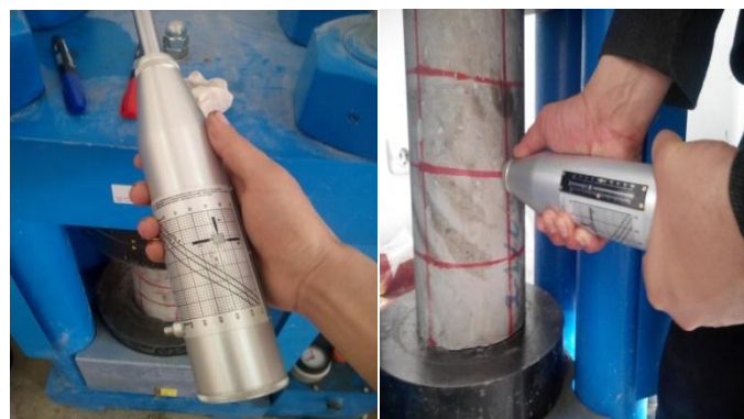
Figure IV.8 : Principe de l'essai scléromètre.
