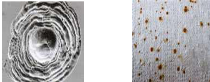
Fig. I. 4. Corrosion par piqûres [1]
