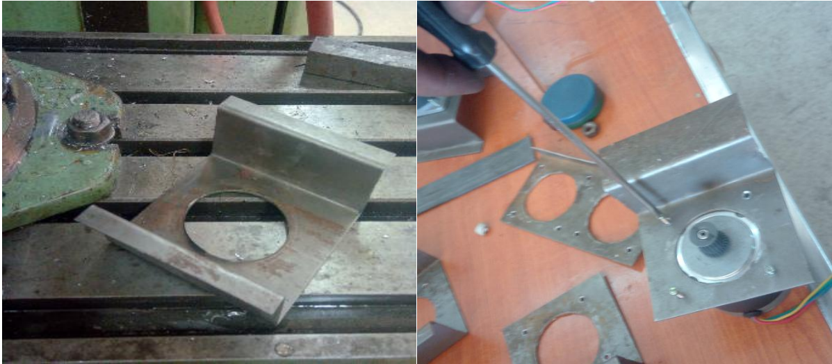
Figure- IV.9 supports des moteurs
