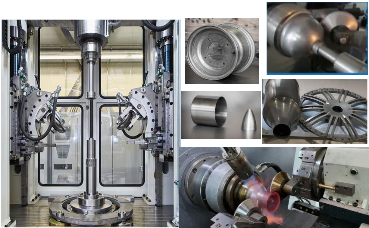
Figure I.9: Machine et produits obtenus par repoussage non-conventionnel.
