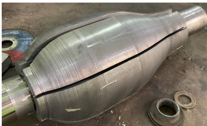
Figure V.10. Gabarit assemblé sur un axe avant polissage
