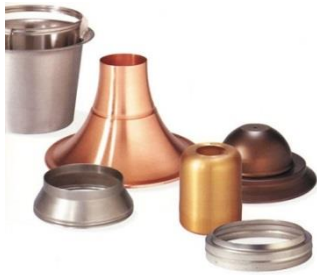
Figure I.10 : Machine et produits obtenues par repoussage conventionnel
