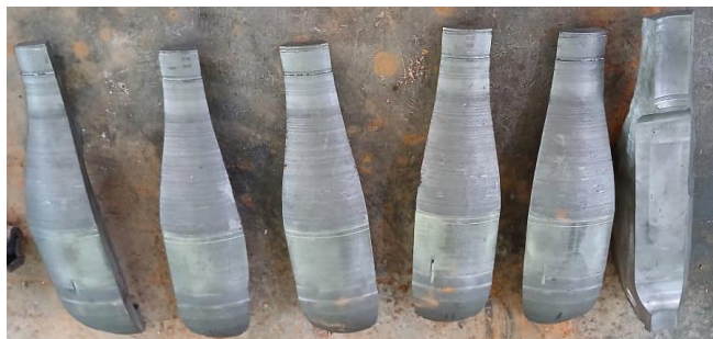
Figure V.8. Découpage du gabarit en morceaux par fraise scie montage sur diviseur
