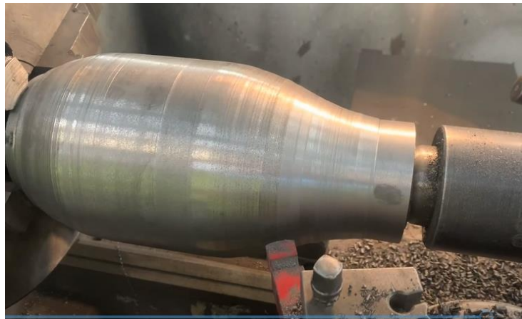
Figure V.6. Obtention de la forme extérieure du gabarit
