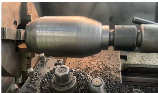
Figure V.3. Ebauche de la forme du gabarit Par Chariotage extérieur
