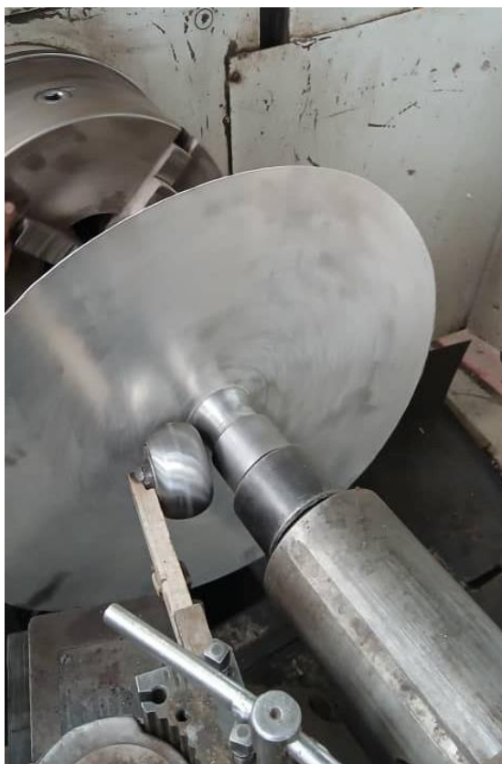
Figure V.10. Gabarit assemblé sur un axe avant polissage
