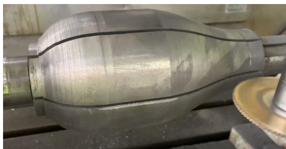
Figure V.7. Obtention de la forme intérieure du gabarit par alésage
