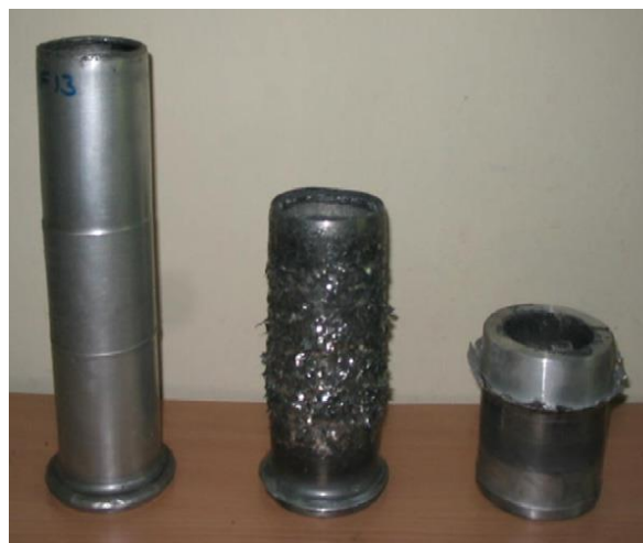
Figure II.10:Tubes fluotournés fabriqués à partir de différents rouleaux.
