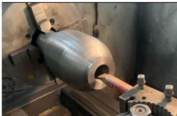
Figure V.7. Obtention de la forme intérieure du gabarit par alésage
