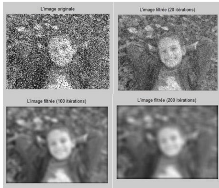
FIG. 2-2 – L'image originale (à haut-gauche) et ses versions filtrées par un filtre linéaire (gaussien)
