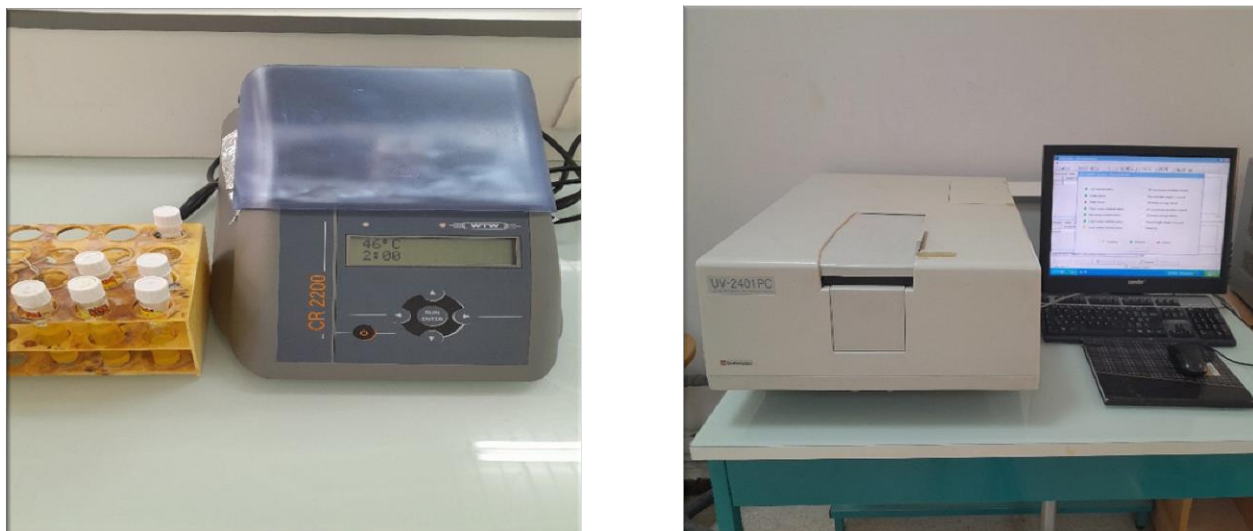
Figure 17. : Thermoréacteur et spectrophotomètre UV-VISIBLE (SHIMADZU 2401 PC ) utilisés
