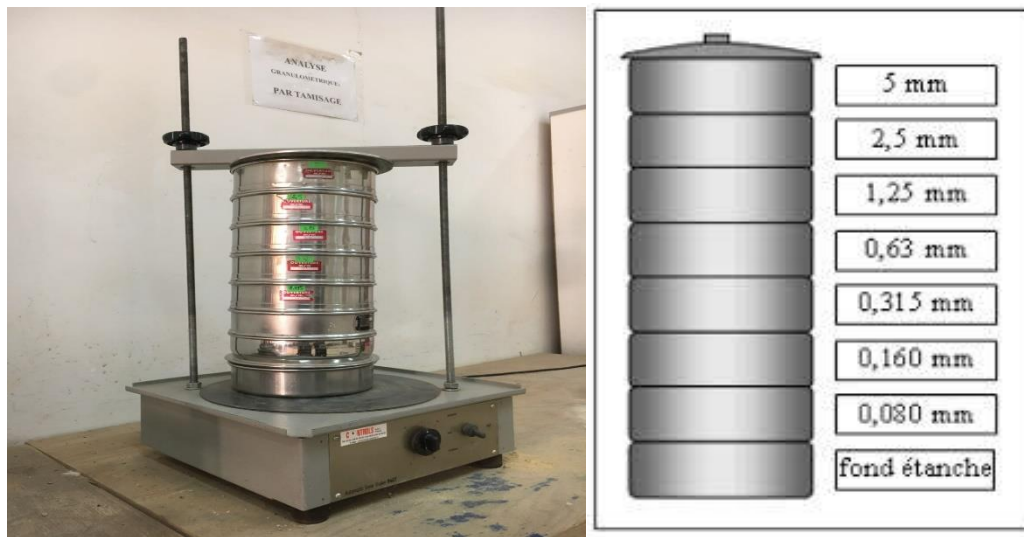
Figure II.5: Appareillage d'analyse granulométrique (tamisage).
