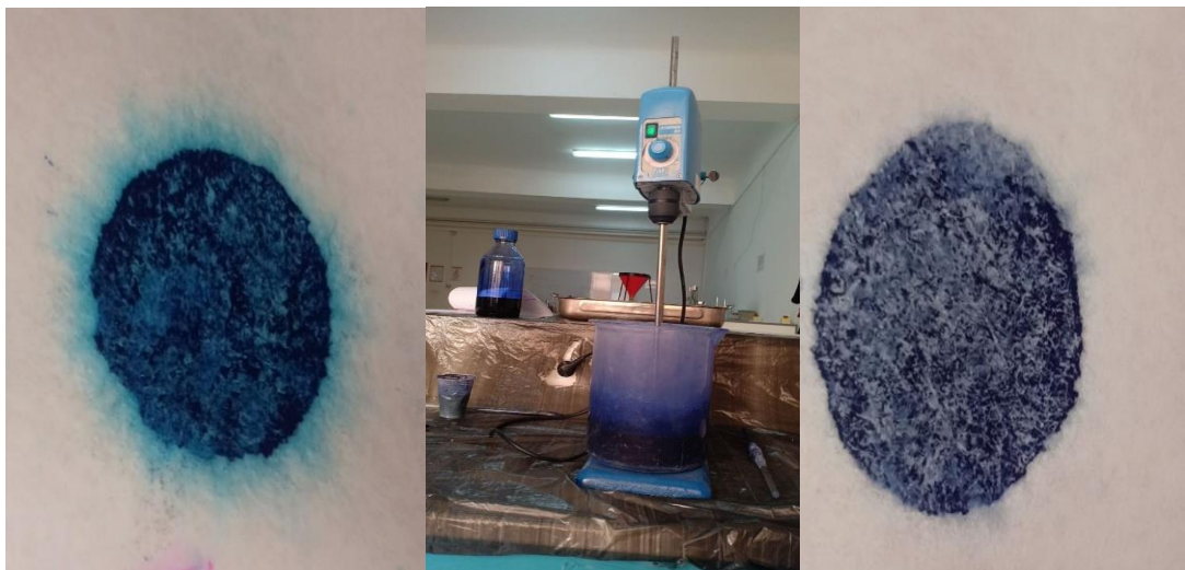
Figure II.10 Appareillage de l'essai au bleu de méthylène.
