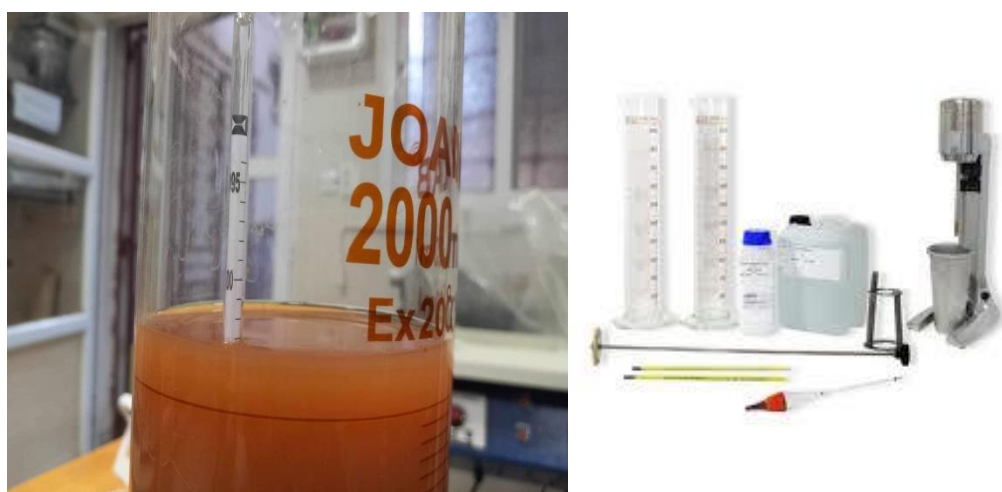
Figure II.6: L'essai de sédimentométrie.
