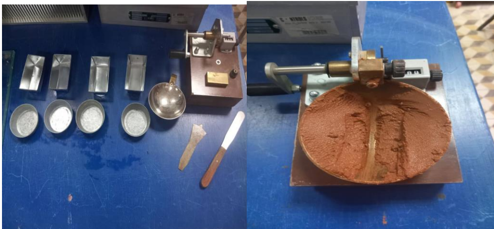
Figure II.7 Appareillage de limites d'Atterberg.
