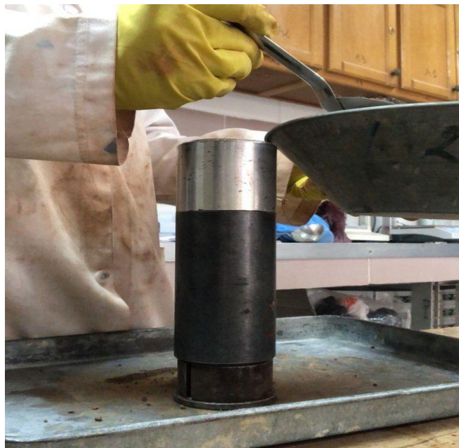
Figure II.10 : Moule des éprouvettes
