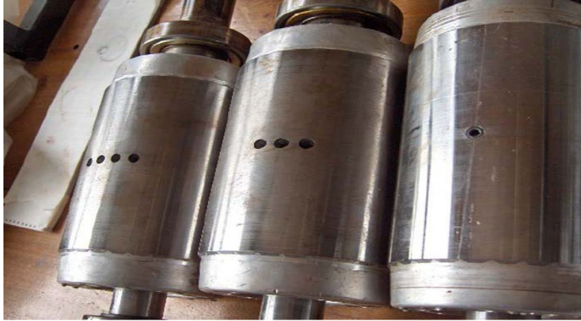
Fig .I.8. Ruptures de barres
