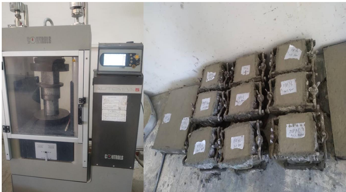
Figure II.18: Machine d'essai de compression et Les moules 10*10*10 cm.
