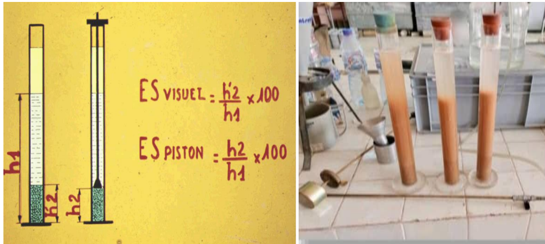
Figure II. 4: L'essai l'équivalent de sable.
