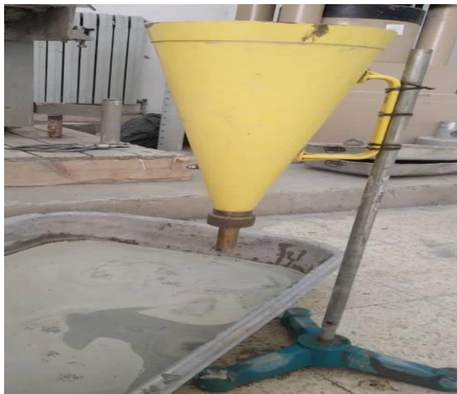
Figure II. 16: Taux de saturation par MEDAFLOW 40.( au cône de March)
