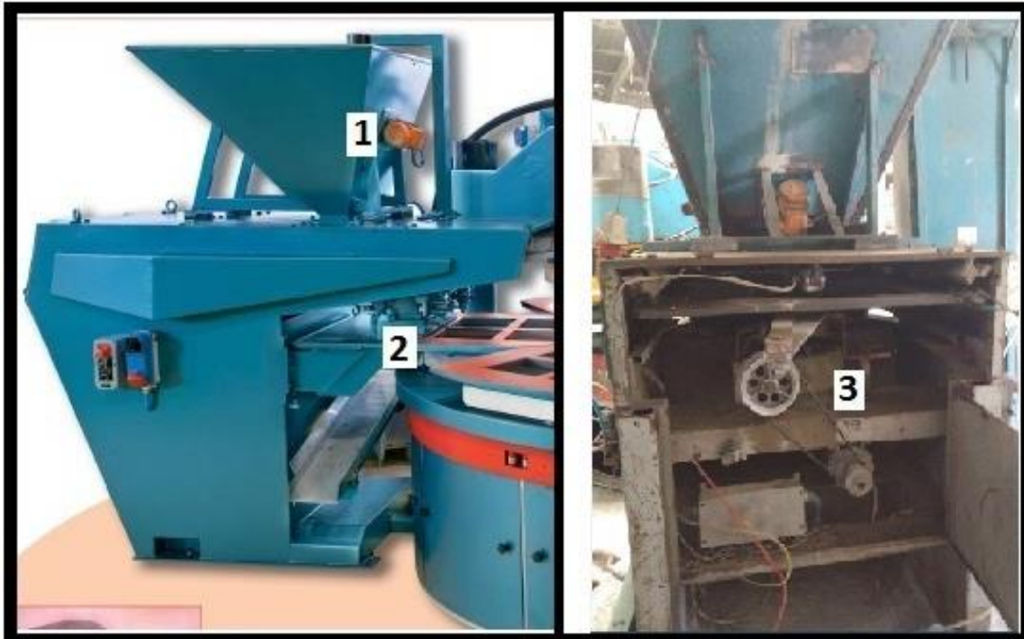
1- vibreur fix trémie 2-tiroir trémie 3- réducteur à vis sans fin
