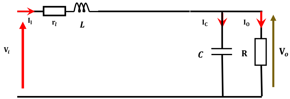
Fig. II.10 : Circuit équivalent pour le commutateur ouvert
