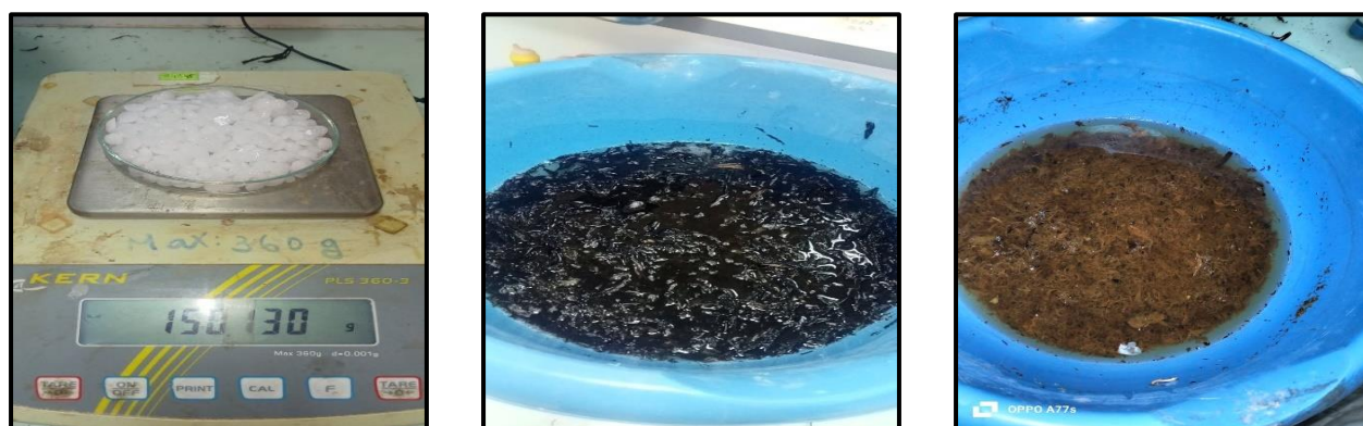
Figure III. 5 : Traitement des algues au NaOH.
