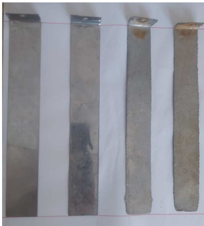
Figure III.21 : Evolution de la forme de l'anode après l'expérience.
