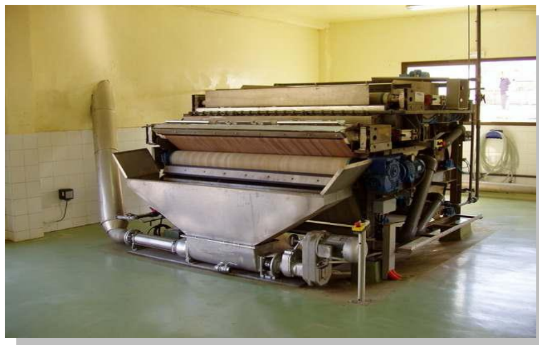
Figure IV.3 : Exemple d'un filtre à bande
