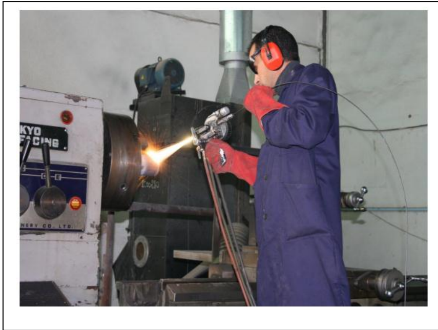
Figure- II.13 : Poste de métallisation à la flamme en fil (MEI)
