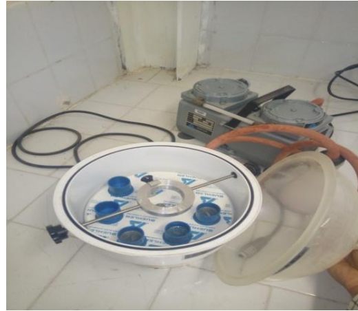
Fig. III-18 moules en chambre sous vide
