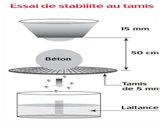
Fig. I.10. Essai stabilité de tamis. [41]
