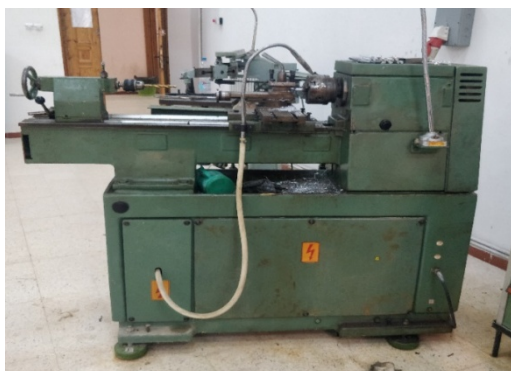
Figure III.2. La machine de soudage par friction rotative utilisée.
