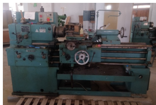
Figure III.2. La machine de soudage par friction rotative utilisée.
