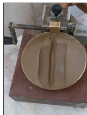
Photo II.2 : Détermination de la limite de liquidité et de la plasticité.
