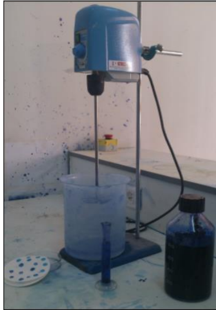
Photos II.3 : Essai au bleu de méthylène.
