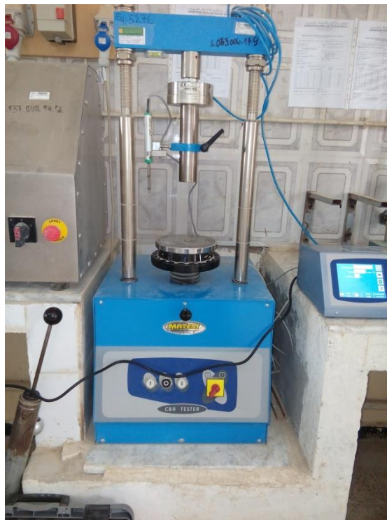
Photos II.4 : Appareil de poinçonnement (essai CBR).
