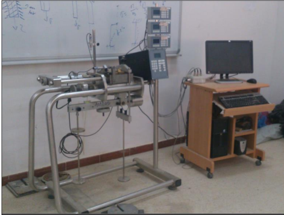
Photo II.8 : appareille de cisaillement direct.
