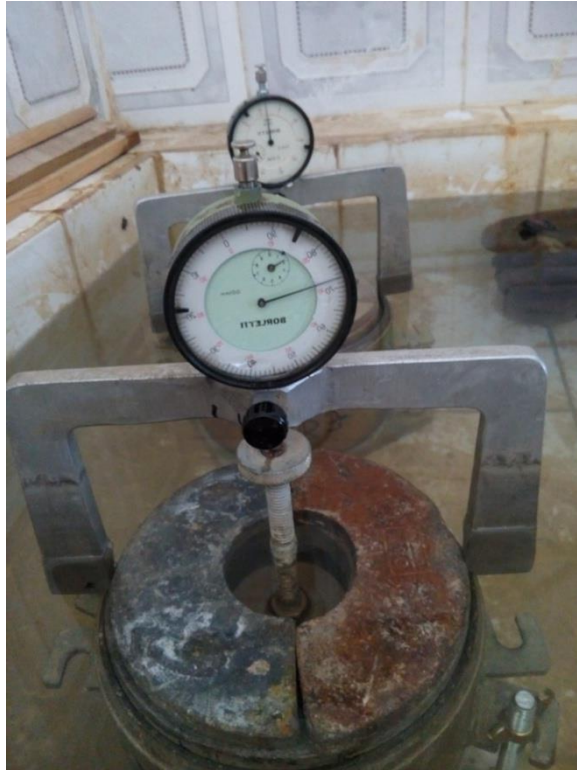
Photos II.5 : Imbibition des échantillons (essai CBR).
