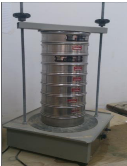
Photo II.1 : Analyse granulométrique par tamisage.
