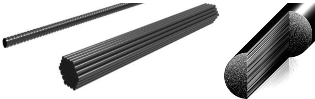
Figure I. 13 Tige composite à renfort unidirectionnelle en fibres de carbone [5]
