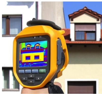
Figure I.7 : Mesure des déperditions thermiques par caméra thermique [6]
