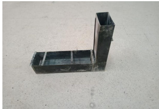
Fig V. 2 Essai de la boîte L
