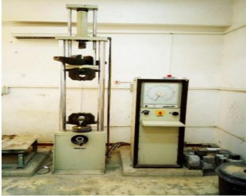
Fig V. 6 L'appareil de l'essai de traction par flexion
