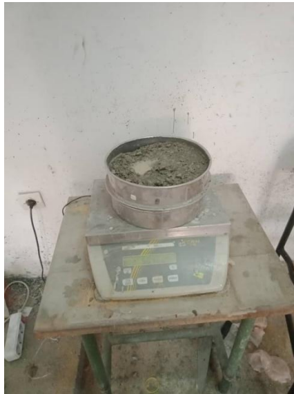
Fig V. 4 Essai de la stabilité au tamis
