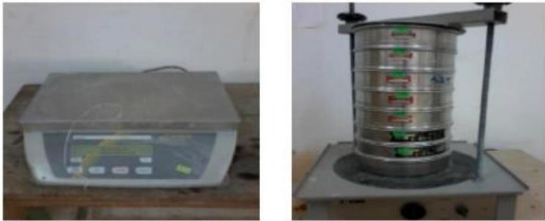
Fig IV. 1 Matériels utilisé pour l'analyse granulométrique
