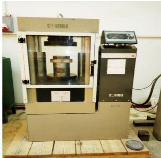
Fig V. 5 L'appareil de l'essai de compression
