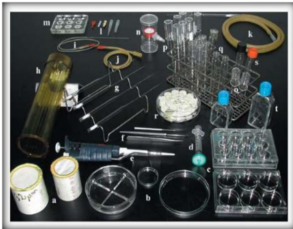
Figure 2: Les éléments de verrerie couramment utilisés pour l'isolement des algues (Andersen, 2005).
