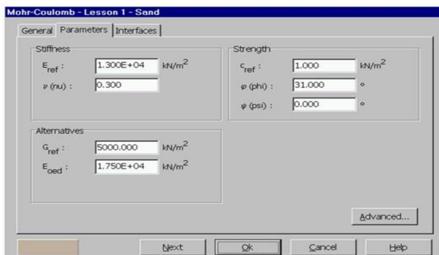
Figure 3.7 : Propriétés des sols (onglet Paramètres du modèle de Mohr-Coulomb)
