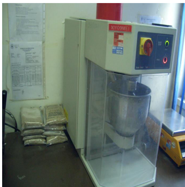
Figure 3.15 : Malaxeur automatique de mortier (Laboratoire de la Cimenterie Ain Touta).
