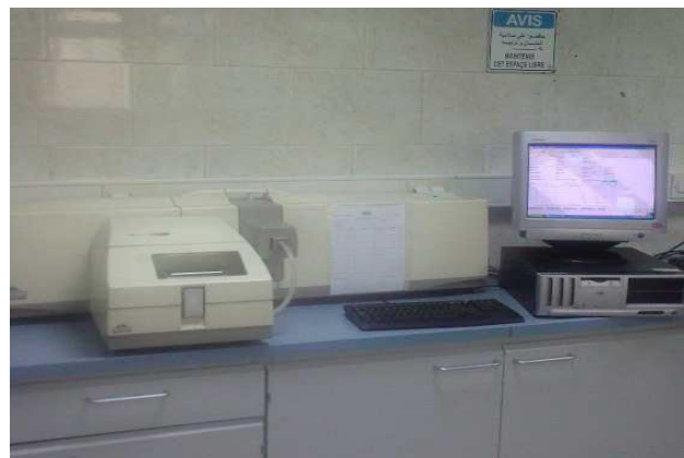
Figure 3.13 : Appareil granulométrie à laser de type MASTERSIZER (Lafarge).
