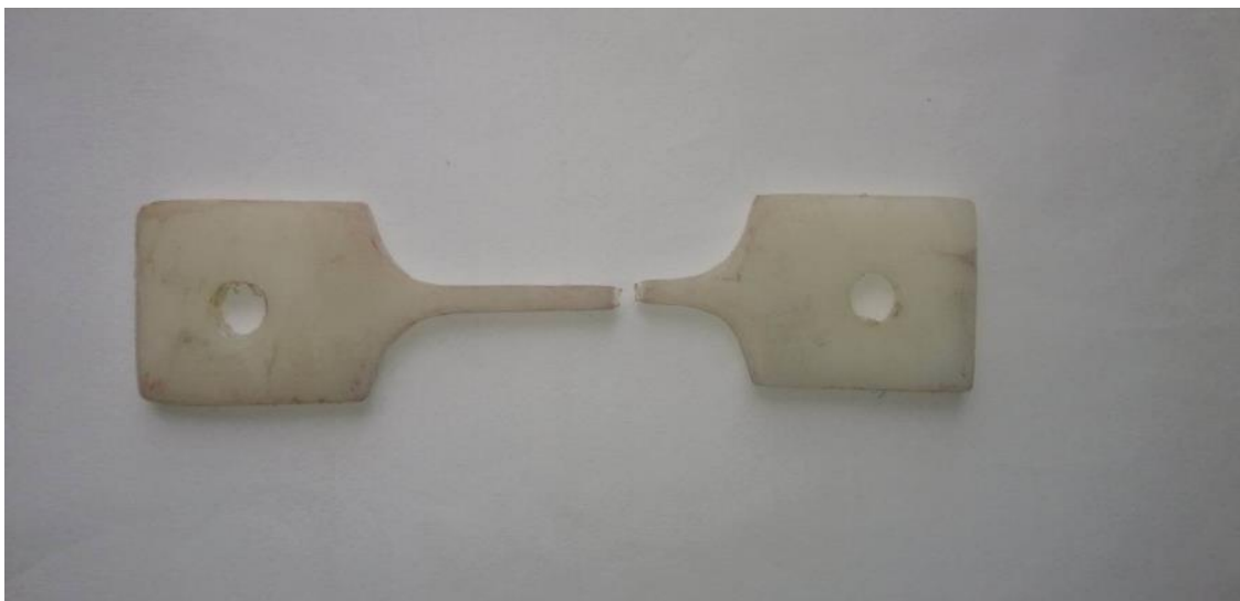
Fig IV.1 : Éprouvette de traction après rupture.
