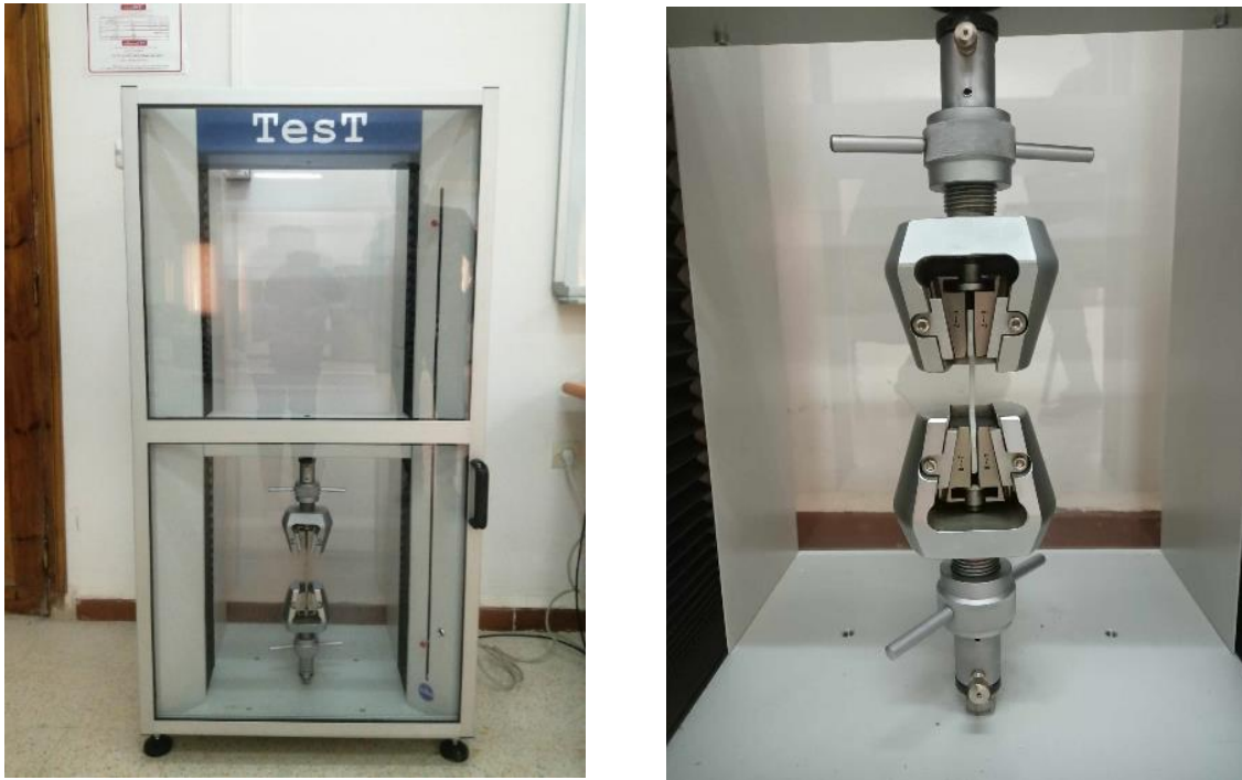
Fig III.4: Machine d'essai en traction type de 112.
