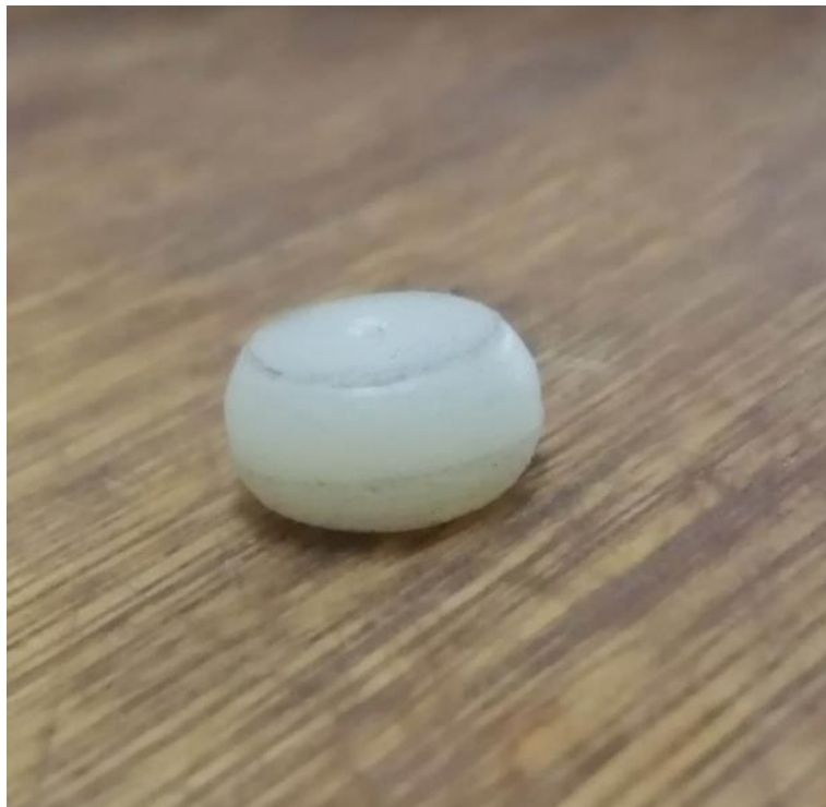
Fig IV.3 : Éprouvette de compression après déformation.
