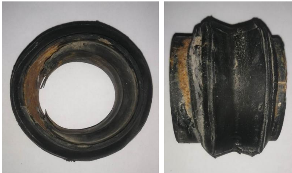
Fig II-2 : Support d'importation endommagé en quelques mois.
