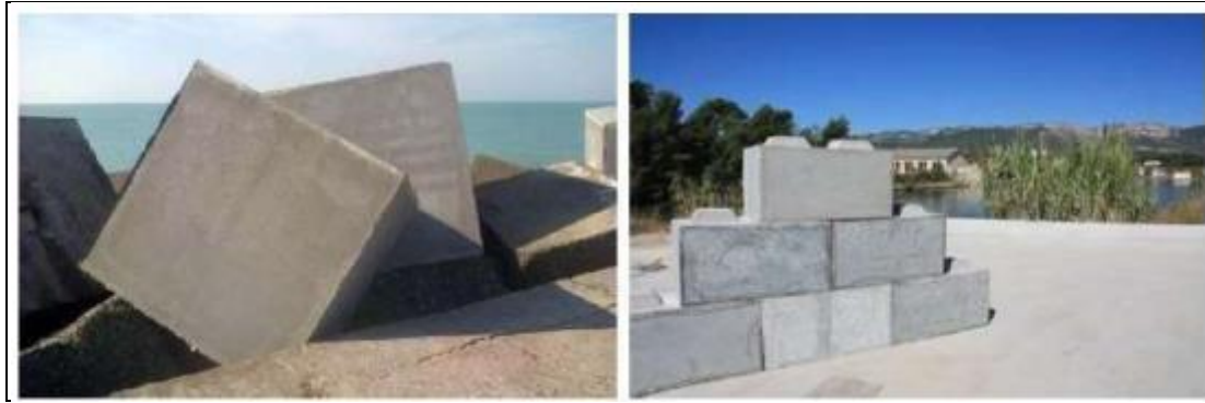
Figure I.10 Blocs de bétons réalisés avec des sédiments non-immérgeables traités (droite : Port de Dunkerque, gauche : Rade de Toulon)
