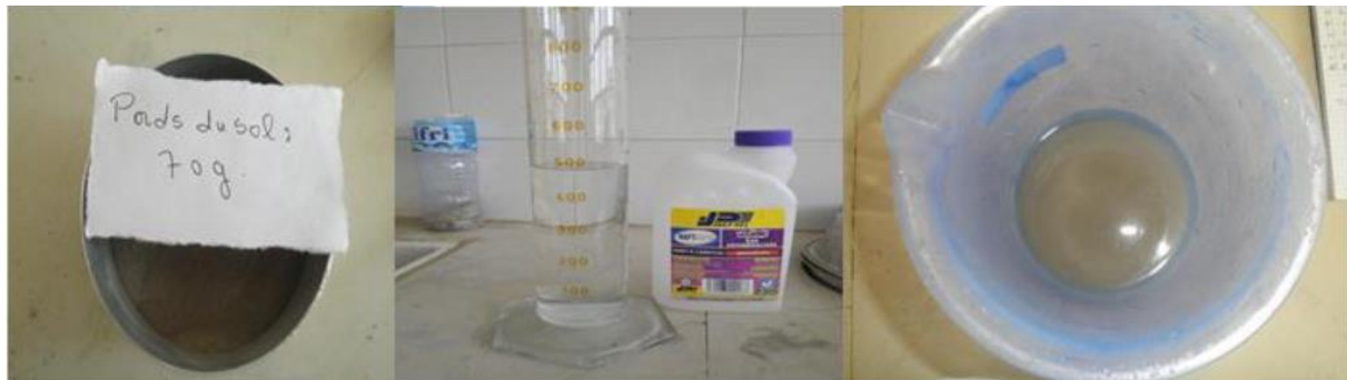
Figure II.14 Matériel d'essai au bleu de méthylène – Essai à la tâche .
