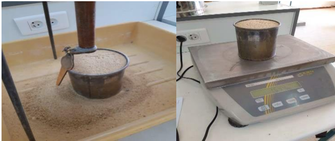
Figure II.4 : Essai da la masse volumique apparente de sable au laboratoire.
