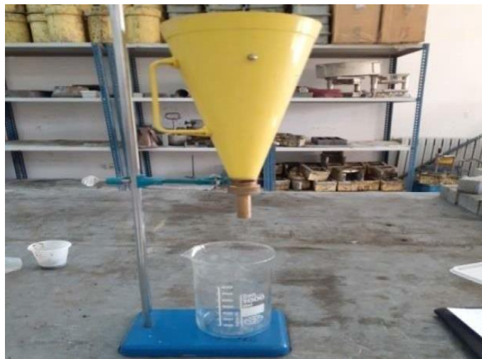
Figure II.12 : Taux de saturation par Super plastifiant. (Conne de March).
