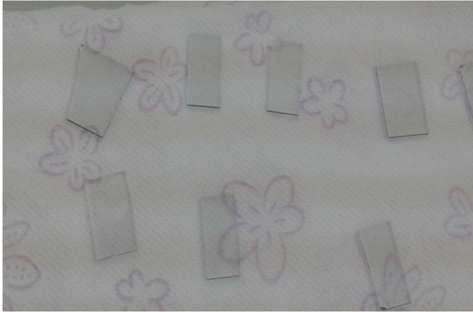
Figure II.9 : Image photographique des substrats utilisés pour déposer les échantillons (ITO+Verre).
