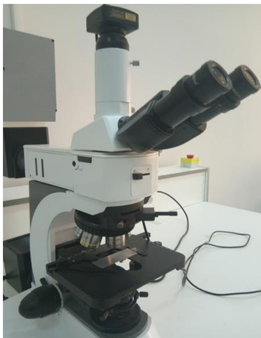
Figure II.1: Microscope optique Model NMM-820TRF, équipé d'une caméra TOUPCAM (UCMOS08000KPB)
