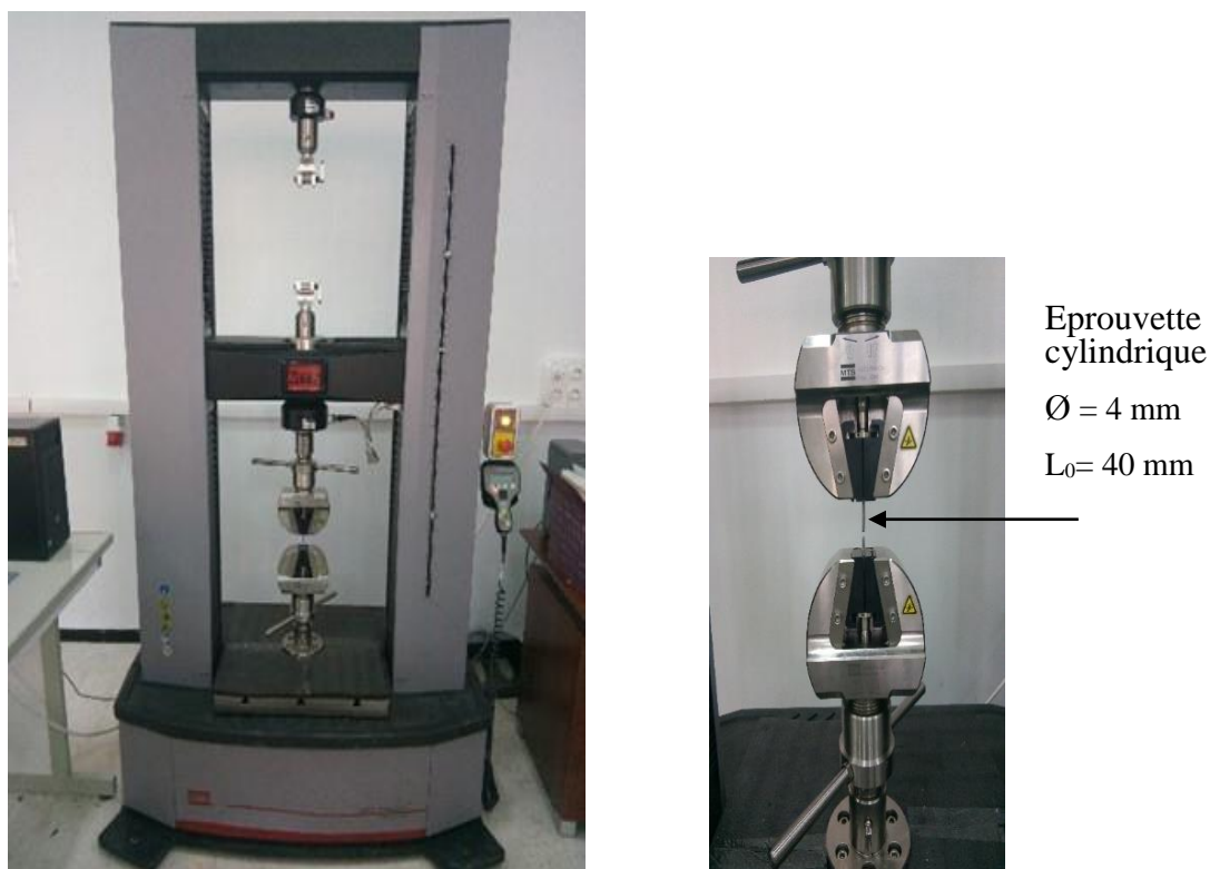
Figure II.13. : Machines d'essais de traction (MTS Criterion model 46 F_{\max}=100\text{KN} )
