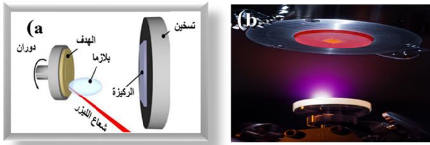
الشكل (6.I): (a) : رسم بياني (b) : صورة لمبدأ الاستئصال بالليزر [71].
