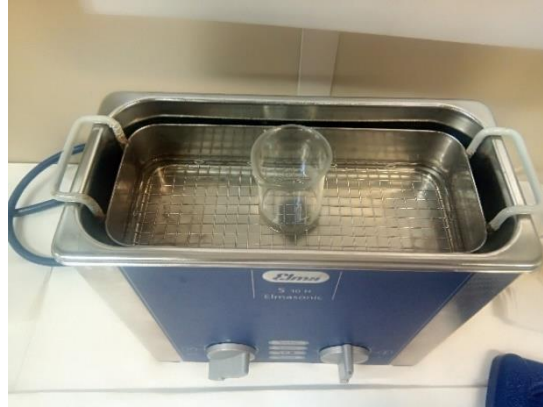
الشكل (4.III): تنظيف الركيعة في جهاز Ultrason.
