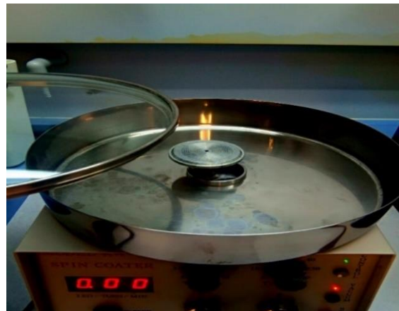
الشكل (5.III): جِهَازُ الطَّرْدِ الْمَرْكَزِيِّ الْمُسْتَعْمَلِ (spin coating).
