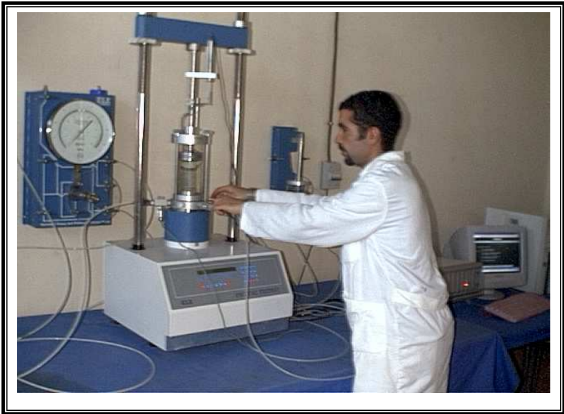
Figure 4.8 Phase de montage des échantillons dans la cellule triaxial
