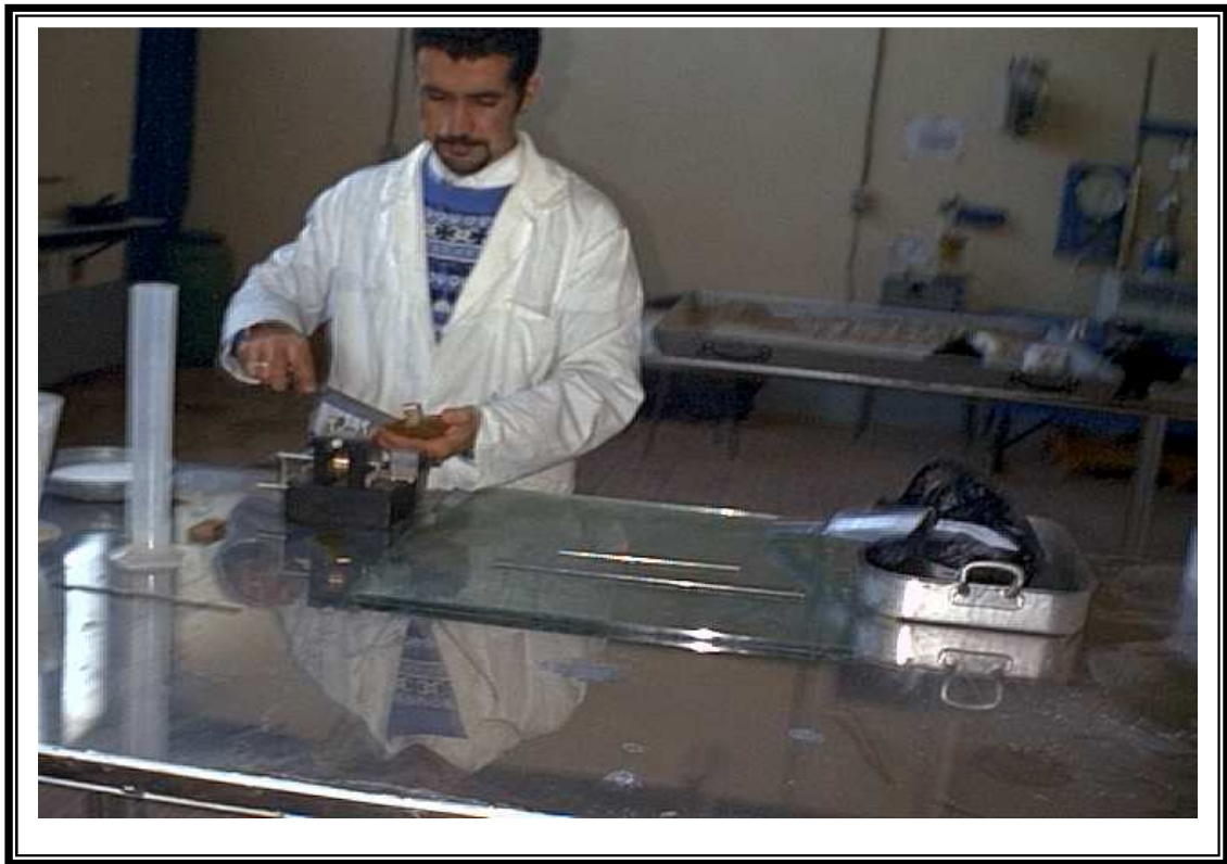
Figure 4.5 Conduite de l'essai des limites d'Atterberg sur le kaolin commercial DD1.
