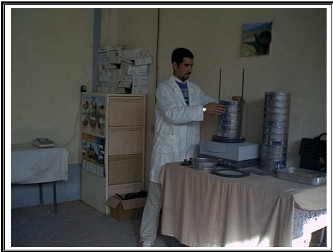
Figure 4.2 conduite de l'essai granulométrique du sable
