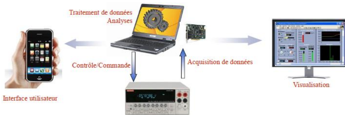
Figure III.1 Schéma synoptique de domaine d'application du Labview
