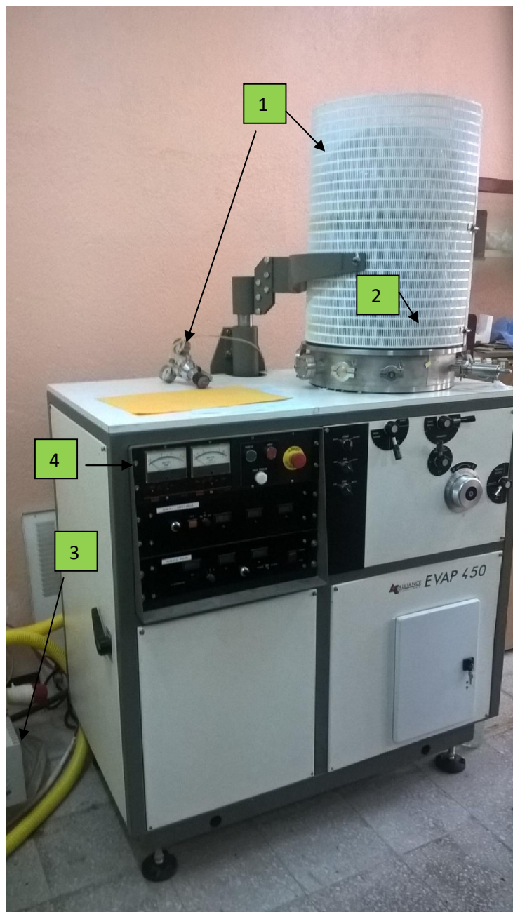
Figure II.5 : Schéma du dispositif expérimental de dépôt par Evaporation thermique type EVAP 450.
