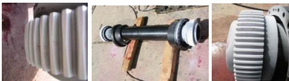
Fig III.9 Piqûres sur la denture de l'accouplement de puissance
