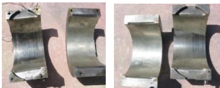
Fig III.12 Coussinet palier 2 turbine hors côte dimensionnelle. Détachement de régule
