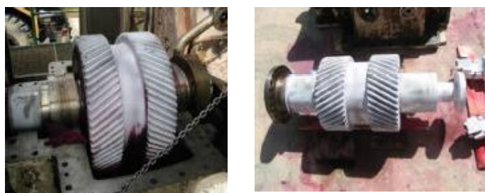
Fig III.11 Roue 5000 du réducteur de puissance en bon état après contrôle au ressuage
