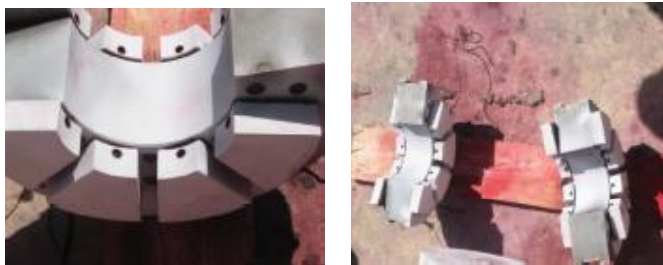
Fig III.10 Butée du réducteur de puissance en bon état après contrôle au ressuage
