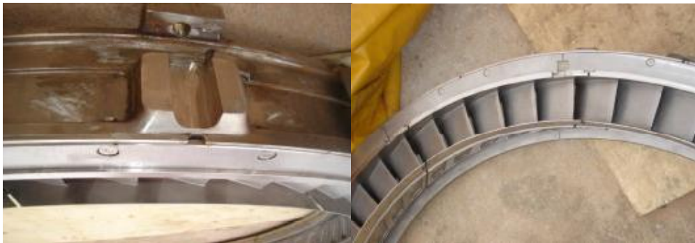
Fig I.8 Directrice fixe de premier étage
