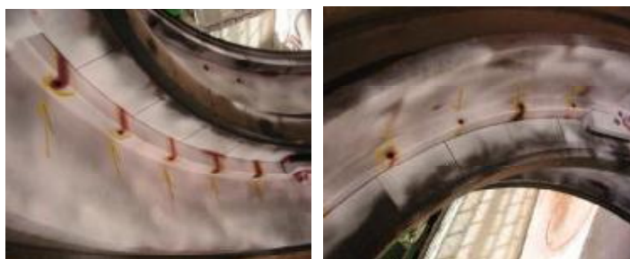
Fig III.7 Fissures à l'intérieur du corps turbine au niveau de la glissière des sabots 1 er étage
