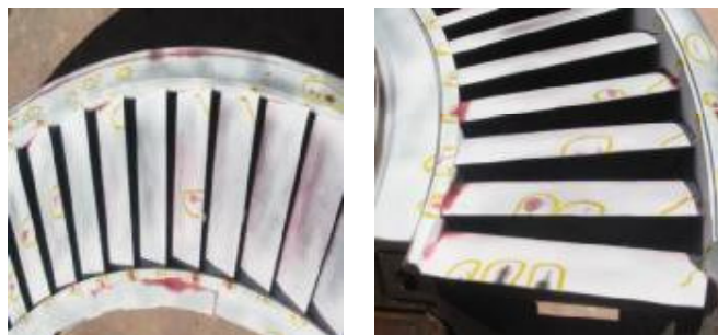
Fig III.6 Fissures sur la directrice 1 ème étage
