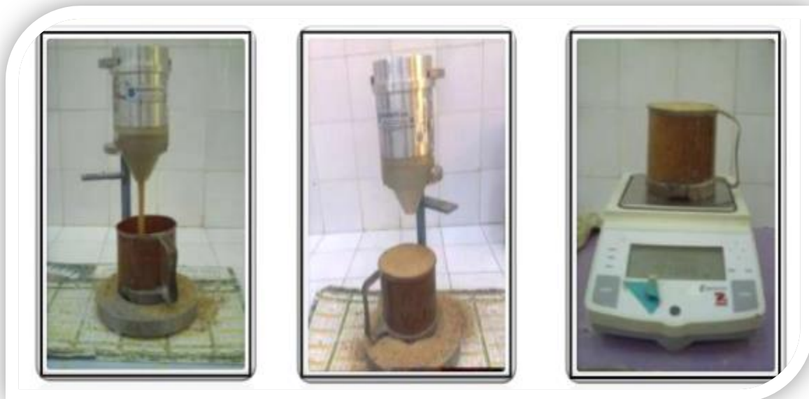
Fig.III.2 Essai de détermination de la masse volumique apparente
