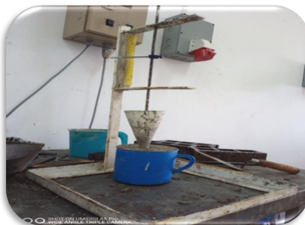
Fig.III.17 Cône d'affaissement du mortier (Laboratoire de génie civil M'sila)
