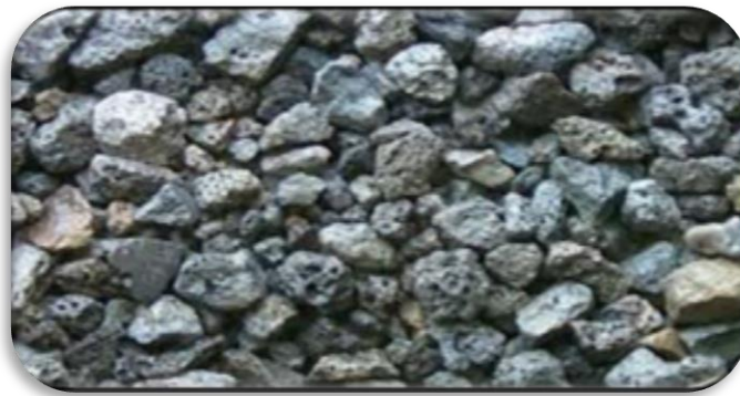
Fig.II.1 Laitier de haut fourneau [54]
